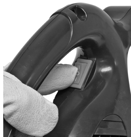
Figura 4-6: Interruptor On/Off en la posición ABAJO
